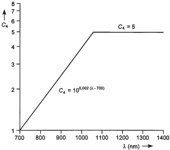
Bild 6: Korrekturfaktor  $C_4$  für  $\lambda = 700$  nm bis 1400 nm
