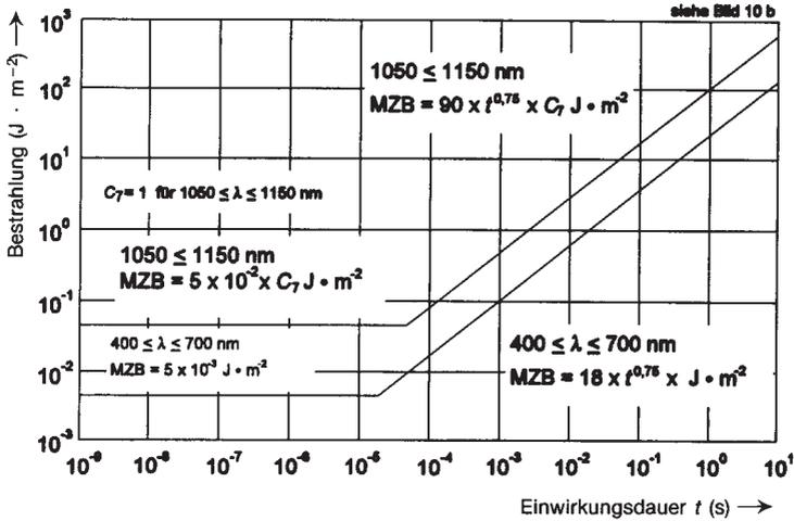
**Bild 10a:** MZB für direkte Bestrahlung des Auges ( $C_6 = 1$ ) durch sichtbare ( $400 \text{ nm} \leq \lambda < 700 \text{ nm}$ ) und ausgewählte Infrarot-Strahlung ( $1050 \text{ nm} \leq \lambda < 1150 \text{ nm}$ ), direkter Blick in den Strahl, für Einzelimpulse oder Bestrahlungen (Expositionen)
