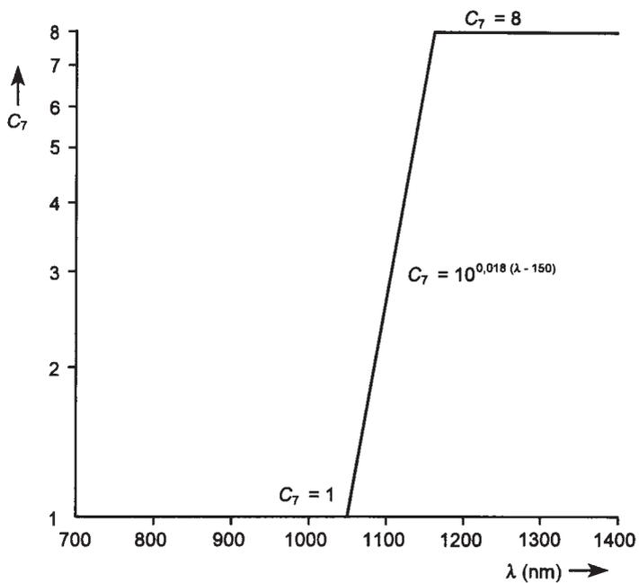
**Bild 8:** Korrekturfaktor  $C_7$  für  $\lambda = 1050$  nm bis 1400 nm
